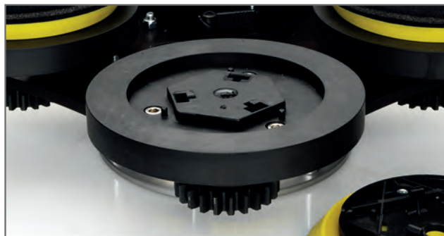
Nacvakávací systém výměnných disků.
