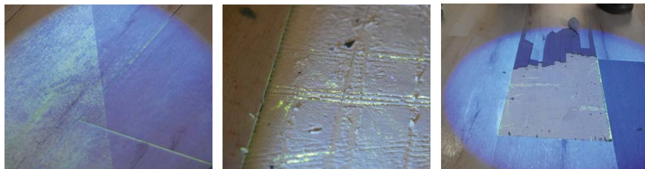
Nasvietená podlaha pomocou UV svetla na kontrolu.
