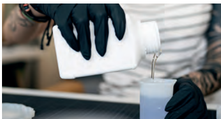
Odměření a namíchání potřebného tužidla.
