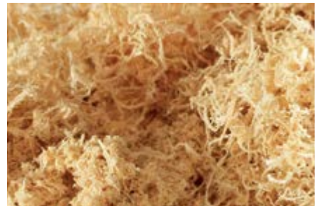
O pó resultante de lixar com abrasivos da concorrência mostra evidências de rasgos das fibras.
