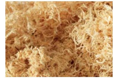
O pó resultante de lixar com produtos da concorrência, mostra evidência de rasgo das fibras.
