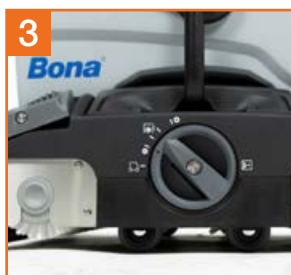
3. Nastavte střední úroveň tlaku kartáčů.
